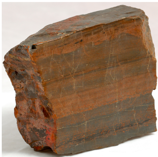
Sl. 19. Laminiran tufit. Zrna kalcedona prepojena s cinabaritom v tufitu. Zgoraj vidimo bolj ali manj razvito obremenitveno teksturo. Nekaj delcev se je že skoraj odvojilo od zgoraj ležeče plasti in gradijo teksturo 'pogreznenih delcev'. V sredini in spodaj različno razvite postopne zrnivosti. Velikost vzorca 13 x 14 cm. Odkopno polje Kropač I/19. Foto: Jani Peternejl
