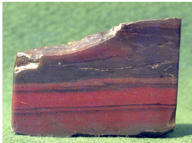
Sl. 11. Vzporedno laminiran langobardski tuft. Menjavajo se lamine in tanke plasti s postopno zrnastostjo orudenih kalcedonskih zrn in piroklastičnega materiala. Kropač IIm/8. Velikost vzorca 10 x 6,5 cm (levi rob vzorca). Foto: Rafael Podobnik
